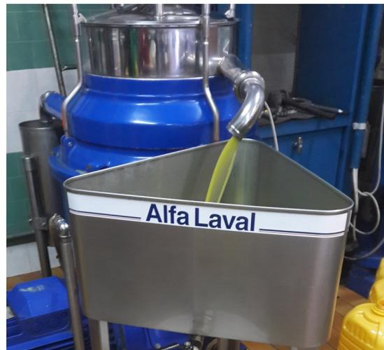
Il prodotto, all'uscita dal separatore centrifugo, contiene ancora residui solidi in sospensione e si presenta torbido, così viene lasciato riposare in vasi di acciaio a contatto con un'atmosfera di azoto per prevenire le ossidazioni, finché il residuo solido si deposita sul fondo del recipiente e l'olio illimpidisce spontaneamente.
