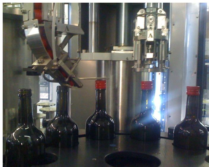
La tappatura e l'etichettatura sono le fasi finali della linea automatica di confezionamento. A seguire le bottiglie vengono poste manualmente all'interno di cartoni da 6 e spedite tramite corriere.
