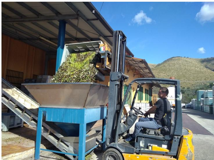
All'arrivo delle ceste, le olive vengono pesate e scaricate con il muletto all'interno dell'imbuto che le porterà sul nastro trasportatore. Da questo momento in poi le olive non verranno più toccate.
