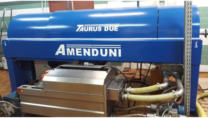
La movimentazione continua della pasta nelle vasche di gramolatura favorisce l'aggregazione delle gocce di olio; una volta pronta, la pasta viene convogliata nel decanter, dove avviene la separazione dell'olio dall'acqua tramite movimento di centrifuga.
